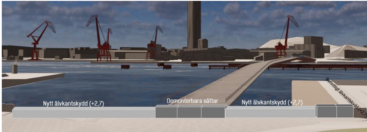
Figur 13. Principiell skiss som visar hur gång- och cykelbrons öppning vid högvattenhändelser kan stängas av manuellt.
